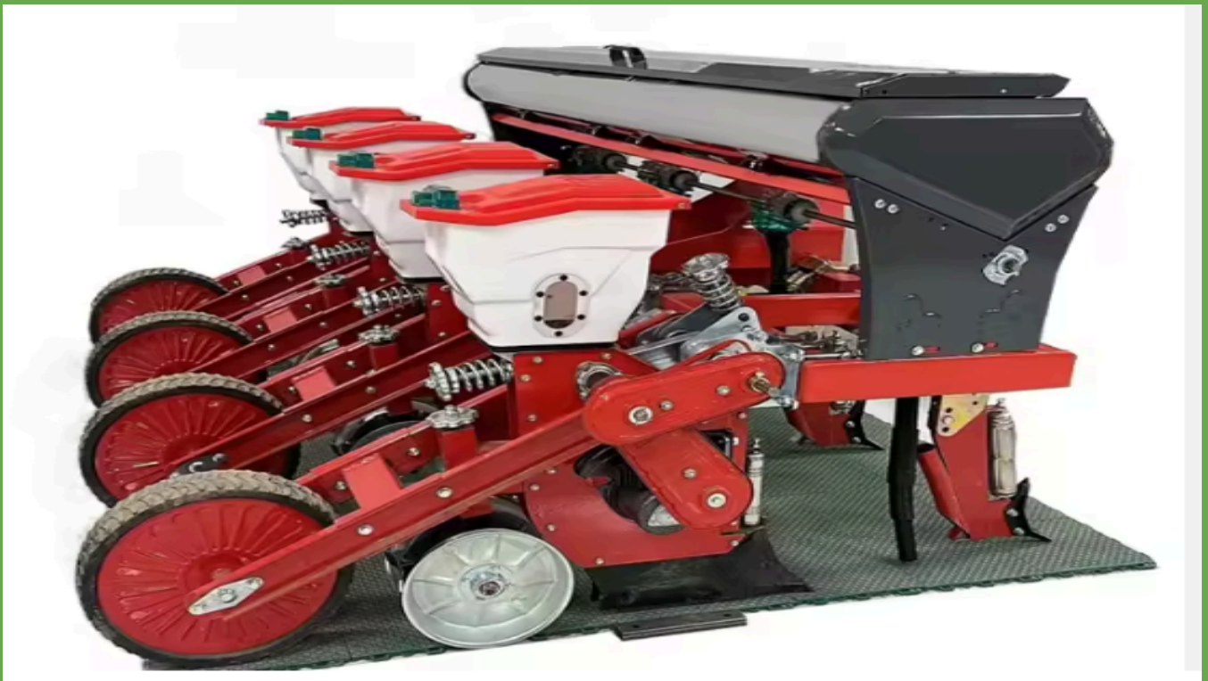
Փոքր 4-շարքային գյուղատնտեսական տրակտոր՝ նախատեսված եգիպտացորենի, սորգոյի և սոյայի սերնացանի համար
